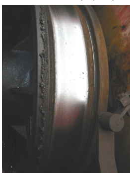
Obr.1 Ukázka opotřebení nákolku z důvodu přičení jeřábu.
