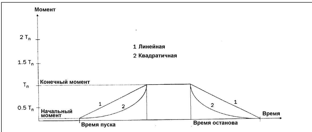
Рис. 34 Управление моментом при пуске / останове
