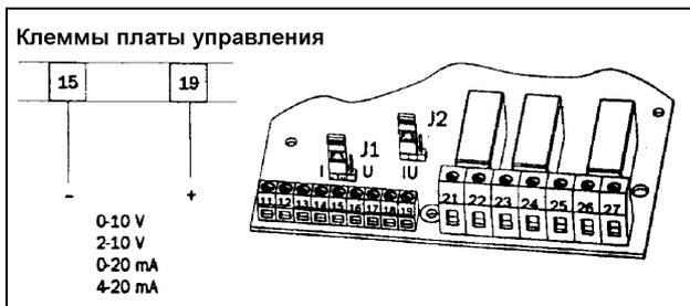
Рис. 43 Подключение аналогового выхода
